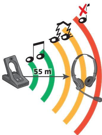
Dans des bâtiments de bureaux normaux, la portée entre le casque-micro et la station de base est de jusqu'à 55 m. Si, en cours d'appel, la qualité sonore se détériore ou que la liaison est complètement interrompue, vous entendez une séquence descendante de bips dans le casque-micro. La LED Liaison ■ de la station de base s'allume en rouge.
