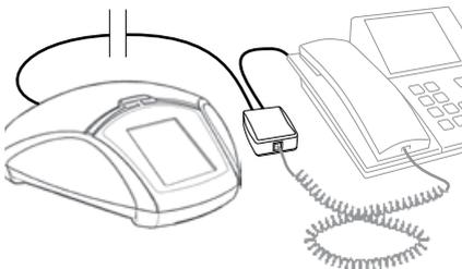
**Débrancher le câble du combiné téléphonique et le raccorder à l'adaptateur téléphonique (voir illustration).**
