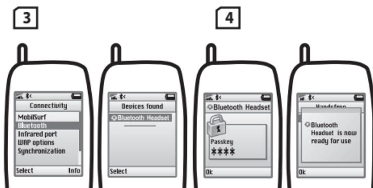
En cas d'échec de l'appairage, mettez l'oreillette Jabra BT3010 en **mode d'appairage manuel**. Assurez-vous que l'oreillette est éteinte. **Appuyez** sur la touche **Réponse/Fin** et **maintenez-la enfoncée** pendant environ **5 secondes** jusqu'à ce que la LED soit allumée en continu. La LED clignotera avant de devenir continue ; **maintenez le bouton enfoncé jusqu'à ce que la lumière soit continue**.
