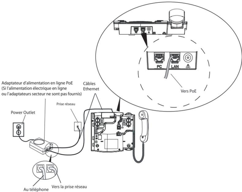
**Note:** Il est conseillé de brancher l'adaptateur d'alimentation à un appareil protecteur contre les surtensions ou à une barre d'alimentation. Tous les câbles Ethernet utilisés doivent être au moins des câbles droits de catégorie 5 et 5e semblables au câble fourni avec votre téléphone.
